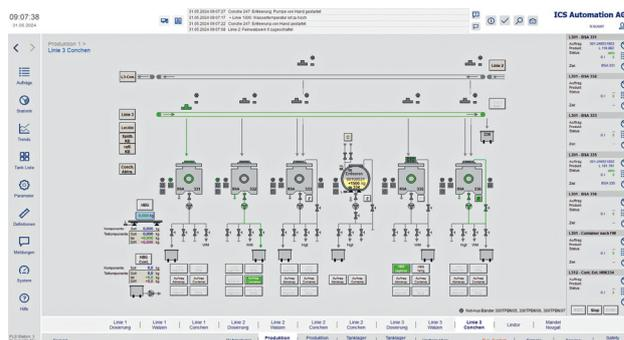
Die Schrittrezepte für den gewünschten Mischablauf sowie die dazugehörigen Parameter werden neu zentral im übergeordneten Prozessleitsystem verwaltet. Dadurch sind einerseits Anpassungen und Erweiterungen der Rezepte einfacher umsetzbar, andererseits wird eine gegenseitige Überprüfung der Dosier- und Schrittrezepte ermöglicht. Dadurch ist auch die Rückverfolgbarkeit sowie die Durchgängigkeit der Daten gewährleistet.
